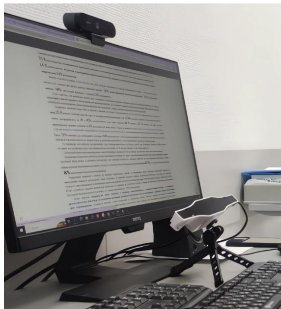
Рис. 1. Айтрекер, с помощью которого выполнялось исследование
