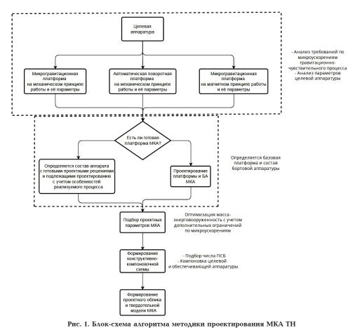
гис. 1. Блок-слема алгоризма методики проектирования МКА 111 с микрогравитационной платформой q. 1. Block diagram of the algorithm of the design methodology for a small technolog
