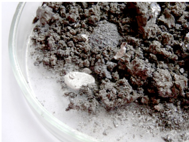
Рис. 6. Внешний вид активированного материала D16T, хранившегося в атмосферных условиях Fig. 6. Appearance of the activated material D16T, stored in atmospheric conditions
