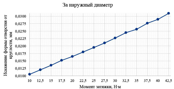
Рис. 2. График зависимости искажений формы отверстия от круглости \Delta r_{s3i}^{\mathcal{F}} в зависимости от момента затяжки M_{s3i} (закрепление за наружный диаметр) Fig. 2. Dependence diagram of hole shape distortion from \Delta r_{s3i}^{\mathcal{F}} roundness as a function of tightening torque M_{s3i} (fixing by external diameter)
