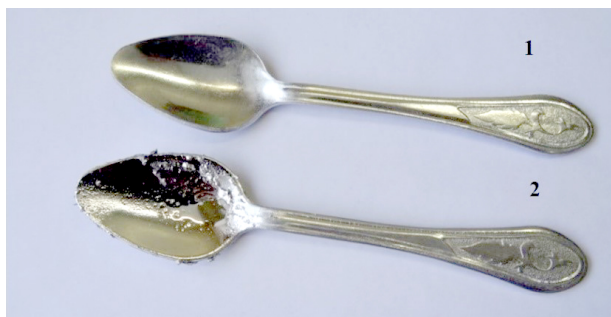
Рис. 3. Фотографии чайных ложек из алюминиевого сплава: 1 — исходной; 2 — после стандартной процедуры активирования Ga-In эвтектикой Fig. 3. Photos of aluminum alloy teaspoons: 1 — the original; 2 — after the standard Ga-In activation procedure by eutectic
