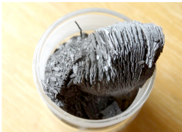
Рис. 7. Фотография чайной ложки из алюминиевого сплава, прошедшей активирующую обработку после хранения 6 месяцев в атмосферных условиях Fig. 7. Photo of a teaspoon made of aluminum alloy that has undergone activating treatment after storage for 6 months in atmospheric conditions
