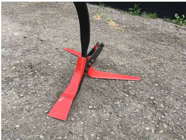
Р и с. 2. Рабочий орган парового культиватора для сплошной обработки почвы. Автор фотографии И. В. Божко, 2023 г.
