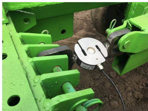
Р и с. 4. Тензодатчик силы растяжения и сжатия ТЕНЗО-М С2Н-2-С3. Автор фотографии И. В. Божко, 2023 г.
