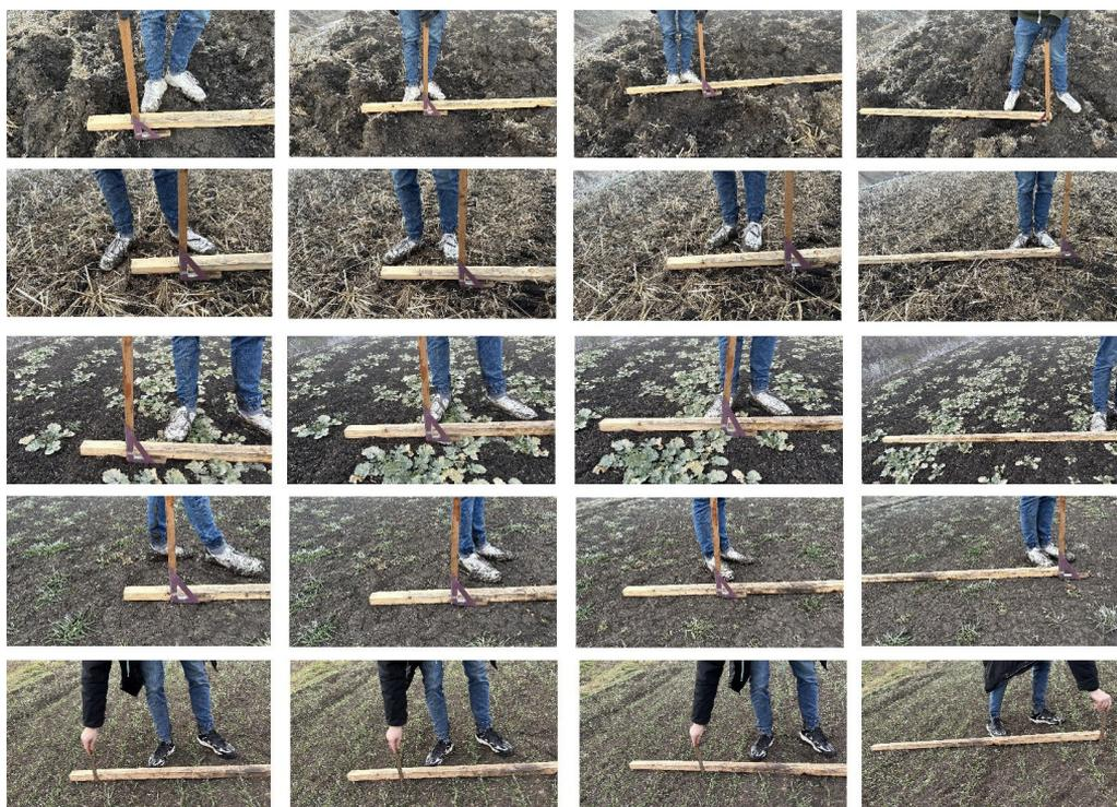
Р и с. 7. Измерение рельефа в точках последовательно справа налево:
