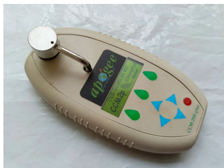
Р и с. 1. Измеритель содержания хлорофилла ССМ-200
