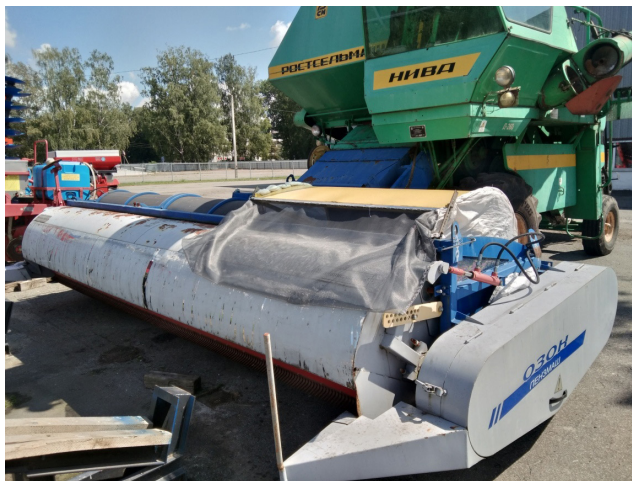
Р и с. 2. Экспериментальная очесывающая жатка
