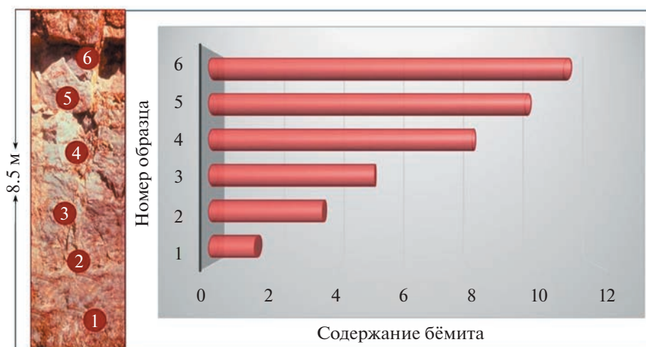
Рис. 1. Образование фазы бёмита при термическом разложении гиббсита.
