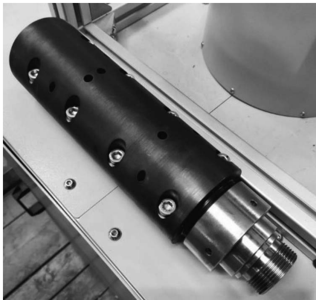
Рис. 1. Общий вид аэрогидродинамического узла.
