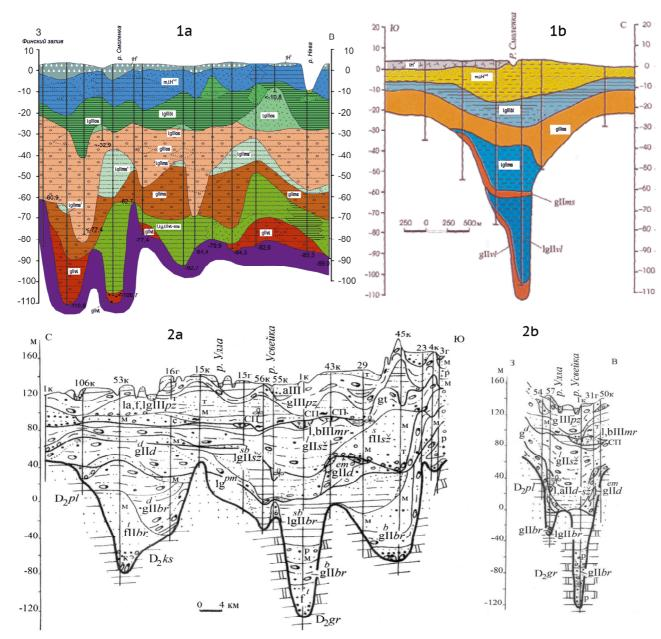
**Рис. 4.** Разрезы погребенных долин: 1— в Санкт-Петербурге, на Васильевском острове: а— продольный (автор), b— поперечный (Ауслендер и др., 2002); 2— Чашникской (Комаровский, 2009): а— продольный, b— поперечный.
