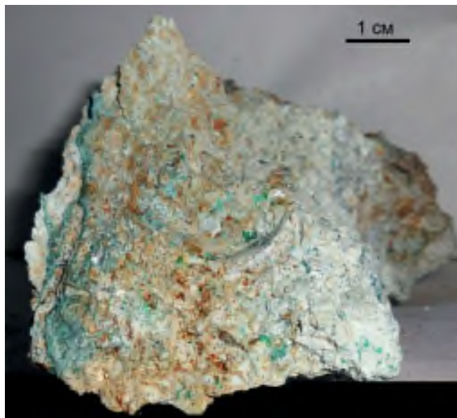
Рис. 11. Гидротермальная атакмит-тальковая постройка с гидроксидами железа (бурое). Станция 36L241d
