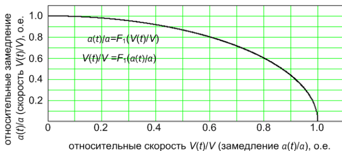
Рис. 7. Зависимость относительной скорости состава от замедления и обратная зависимость
