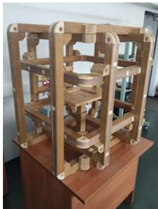
Рис. 6. Один из двух одинаковых блоков системы гипомангнитной экспозиции, реализованной в ИОФ РАН, компенсирует внешнее МП и позволяет снизить флуктуации однородного окружающего МП в несколько тысяч раз.
