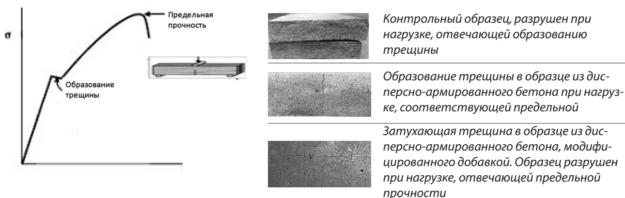
Рис. 8. Схема испытания образцов и регистрируемые параметры при испытании (составлена авторами) Fig. 8. Samples testing scheme and recorded parameters (authors' diagram)
