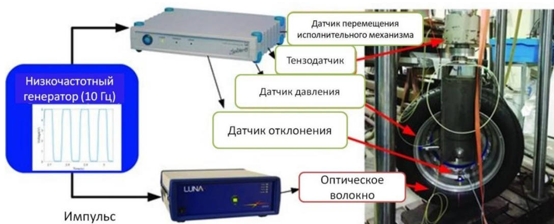
Рис. 3. Экспериментальная установка оценки статической вертикальной нагрузки на основе волоконно-оптических распределенных датчиков [34]
