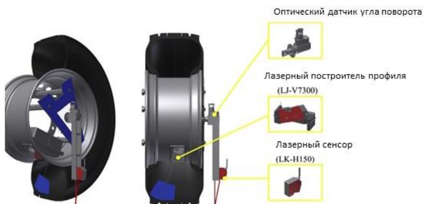
Рис. 1. Лазерная система измерения деформации шины [31]
