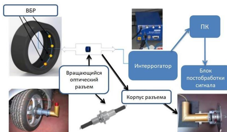
Рис. 4. Схема экспериментальной установки оценки деформации шины на основе ВБР [3]
