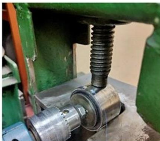
Рис. 5. Экспериментальная установка для оценки деформации внешнего кольца роликового подшипника на основе АВБС [25]
