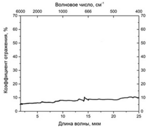
Рисунок 4 – Спектральные коэффициенты отражения аэрозольной краски ABRO в диапазоне длин волн от 1,7 до 25 мкм
