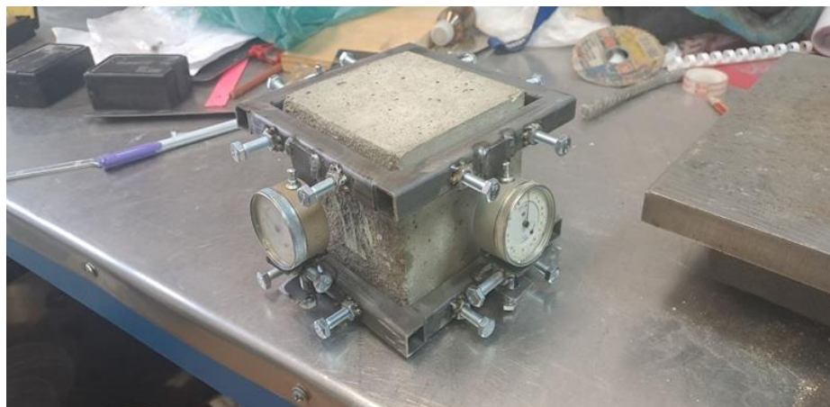
Рис. 1. Стальная траверса для закрепления индикаторов часового типа на бетонном образце Fig. 1. Steel crossbeam for fixing clock-type indicators on a concrete specimen
