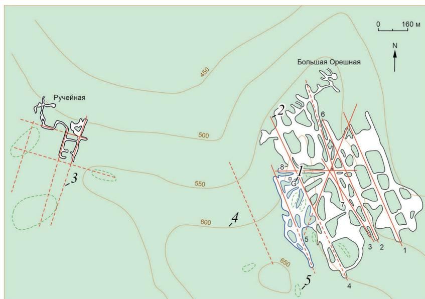
**Рис. 3.** Выявленные разломы и привязка карты пещер Большой Орешной и Ручейной к дневной поверхности. 1 — площадка геофизических измерений; 2 — разломы, их номера (названия в тексте) и соответствующие им линейные структуры пещер; 3 — предполагаемые разломы; 4 — горизонтали с отметками высот; 5 — поверхности выравнивания; тонирование — массивы пород.
