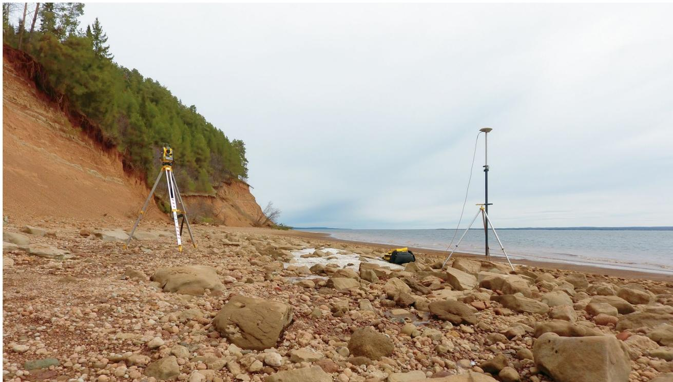
**Рис. 2.** Работа навигационного оборудования на реперных точках.
