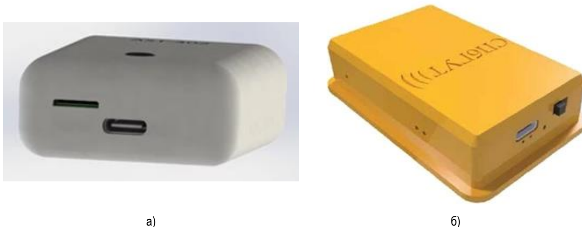
Рис. 4. Электронные идентификаторы для БВС на основе сотовой связи: а) «AST-402»; б) «БПСИ 2»
