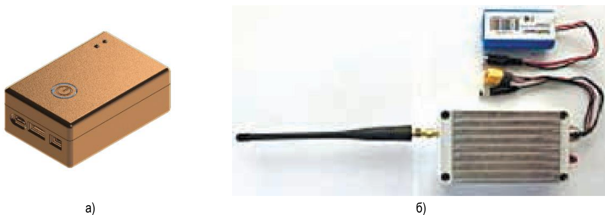
Рис. 6. Электронные идентификаторы для БВС на основе маломощных технологий связи: а) «APNEGA-RID»; б) «Ответчик GoodWAN»
